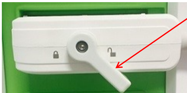
Kuva 30: Avattu anturin liittimen lukitussäädin avattuna
