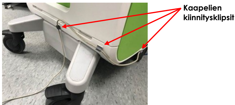
Kuva 4: Polkimen kaapelin kiinnitys
