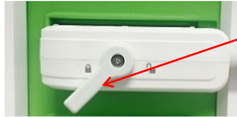
Kuva 21: Anturin liittimen asento
